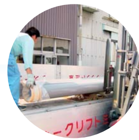
5 浸漬後の鋼管
